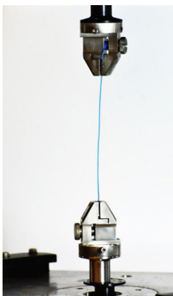
Amir Hooshier, doctorant, testant les propriétés mécaniques d'un fil guide cardiaque. Ses travaux visent à rendre plus sûres les chirurgies cardiaques peu invasives.
