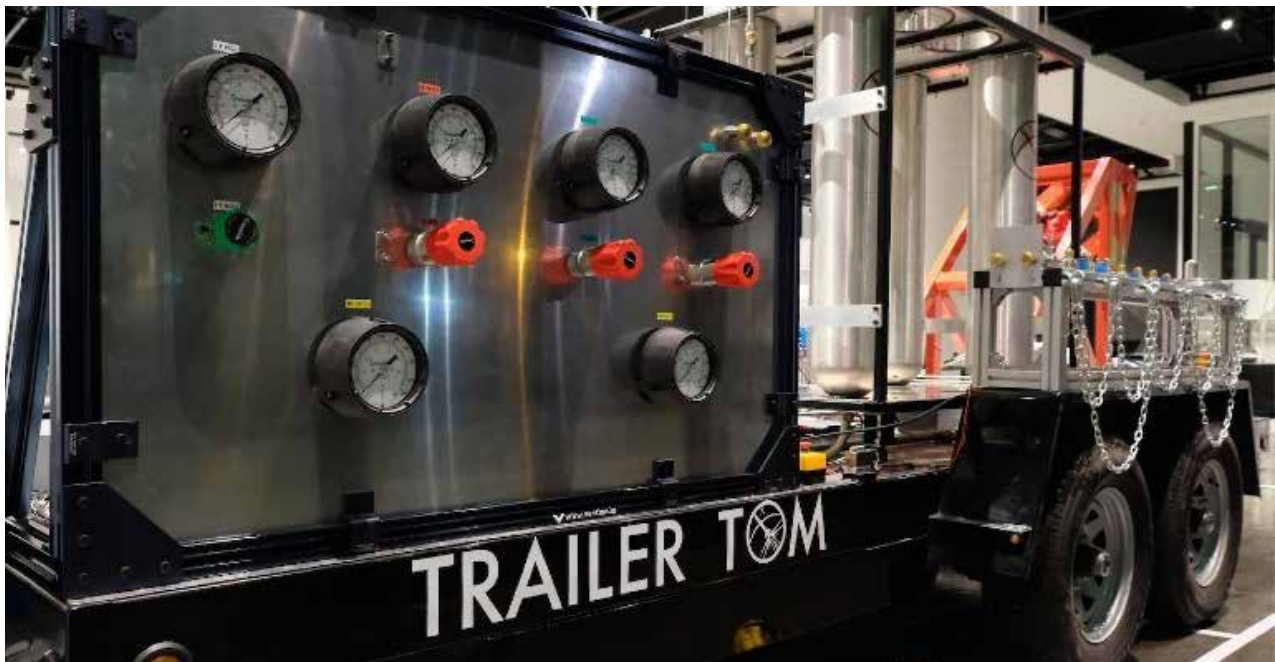
Le banc d'essai de moteur-fusée mobile Trailer Tom — dont le nom évoque une chanson de David Bowie —, construit par les membres du Club spatial de Concordia grâce à un don en nature sous forme de matériaux et de pièces d'équipement d'une valeur de 37 000 $, consenti par Swagelok Québec
